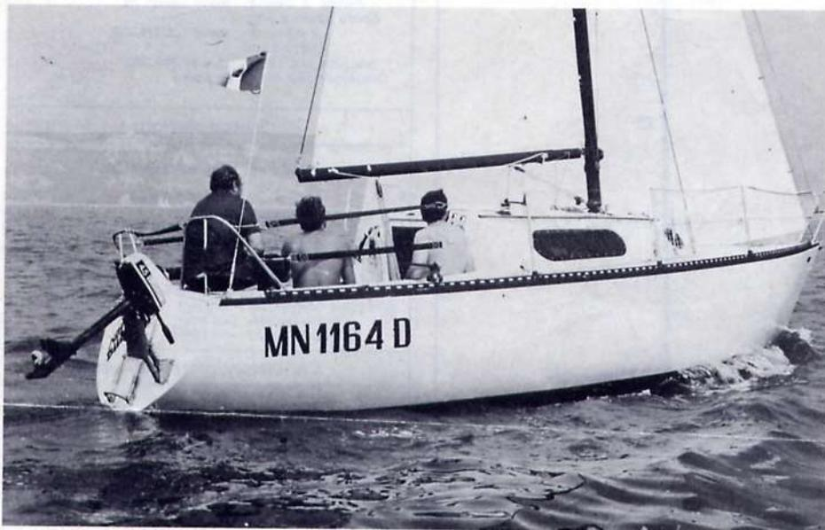
*Di bolina stretta con vento leggero l'Amarage naviga con un buon passo nonostante il sovraccarico. Il fuoribordo sullo specchio di poppa è di sicurezza in caso di avaria dell'entroborso diesel (un sicuro Volvo Penta) o per motorizzare il pram di servizio. Comode per una barca di piccole dimensioni e quindi sensibile al peso, le battagliole del pozzetto di cinghia di nylon.*
